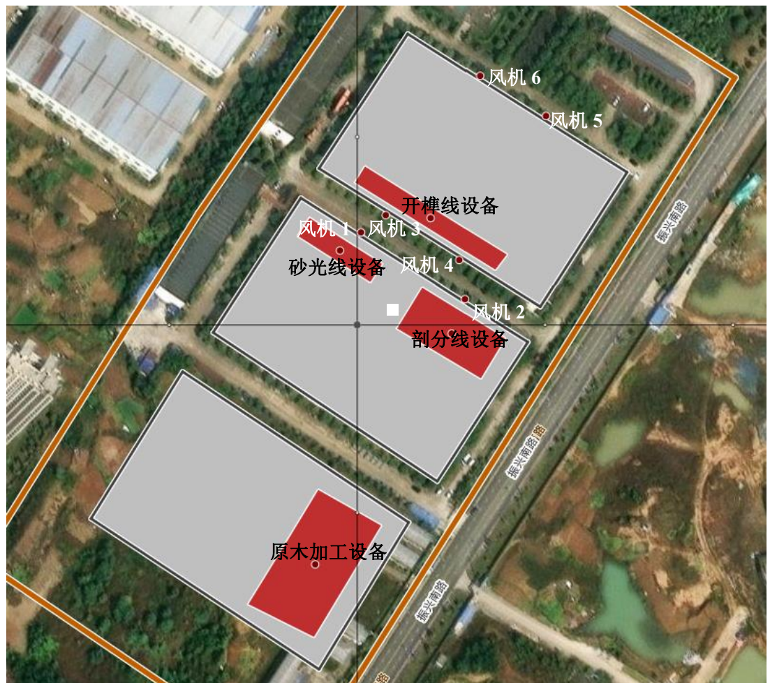
图 4-2 项目主要噪声设备布置示意图
