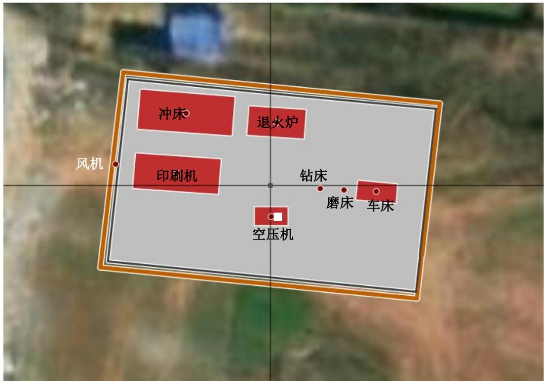
图 4-2 项目主要噪声设备布置示意图
