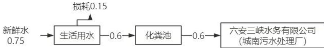
图 2-1 项目水平衡图 ( $\text{m}^3/\text{d}$ )
